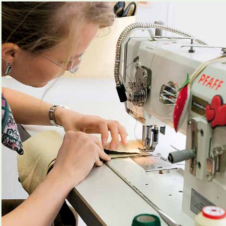
Alles fachkundige Handarbeit: Vom Zuschneiden übers Zusammennähen mit der Pfaff-Säcklermaschine, Nähteklopfen mit der Windspindel und Bügeln bis hin zur Versäuberungsnaht bzw. den Zierstickereien.
