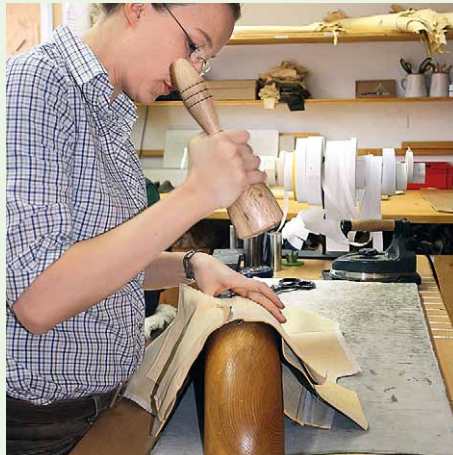
Alles fachkundige Handarbeit: Vom Zuschneiden übers Zusammennähen mit der Pfaff-Säcklermaschine, Nähteklopfen mit der Windspindel und Bügeln bis hin zur Versäuberungsnaht bzw. den Zierstickereien.
