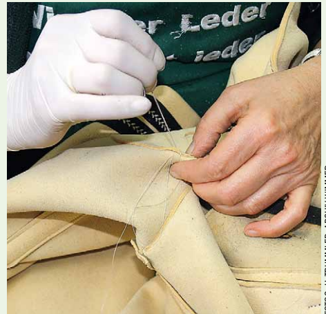
Alles fachkundige Handarbeit: Vom Zuschneiden übers Zusammennähen mit der Pfaff-Säcklermaschine, Nähteklopfen mit der Windspindel und Bügeln bis hin zur Versäuberungsnaht bzw. den Zierstickereien.
